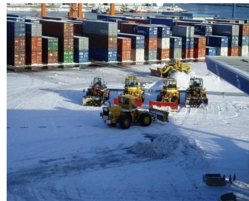
☞ トランスファーレーン、岸壁等はドーザー、ショベルローダーで除雪
