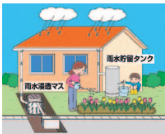
宅地内の雨水貯留浸透施設
