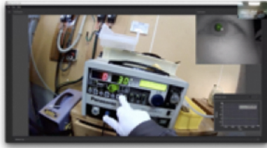
1) 溶接機の設定指示と視点による確認 2) 使用する治具の指示と確認
