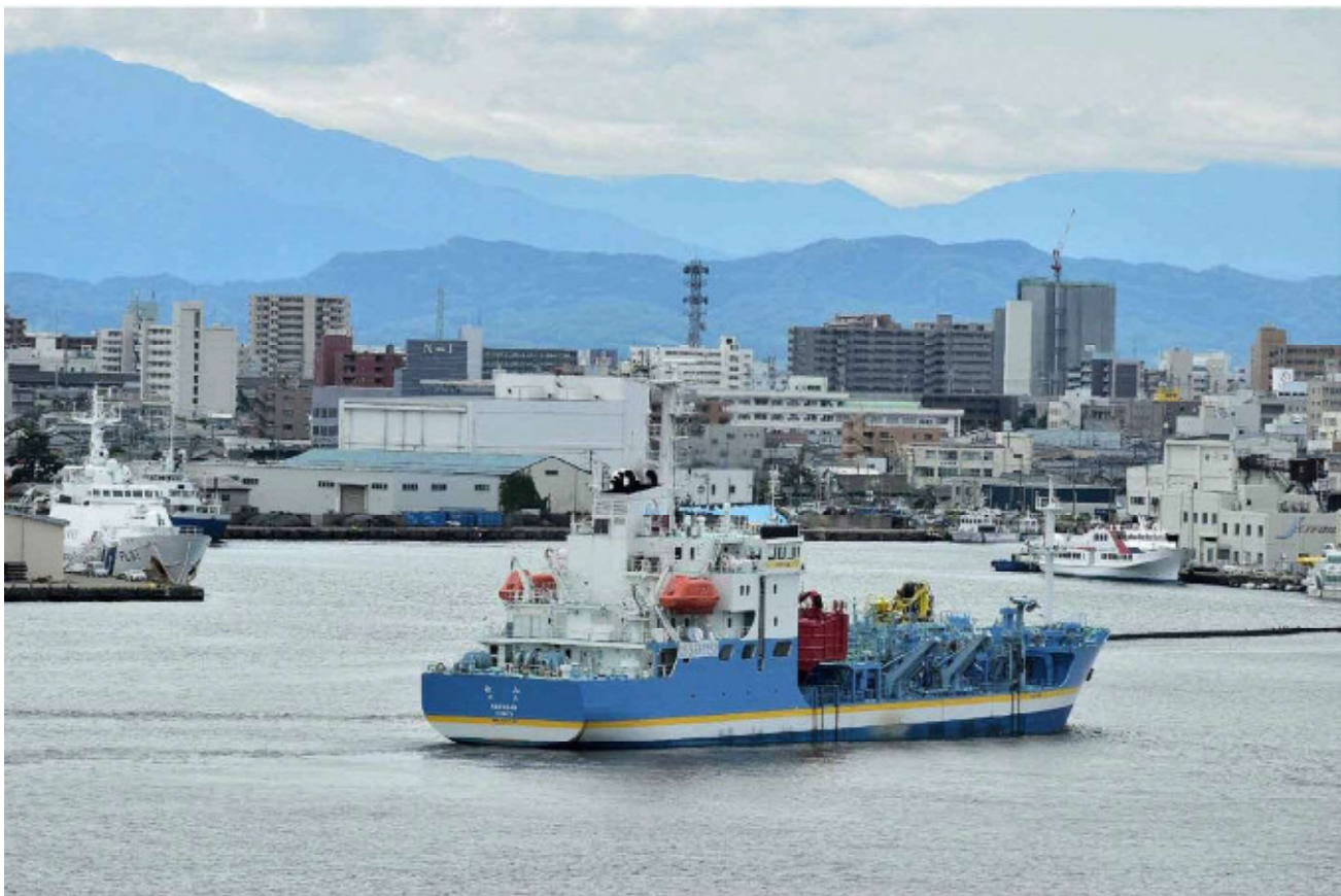
油戻作業をする大型油戻兼油回収船「白山」。普段は新潟西港内の油戻作業を、緊急時には油回収作業を行う。 【総トン数 4,185トン 全長 93.9m 速力 13.1ノット 乗船者数 27名】 ※油戻とは・・・港湾・河川などの底面をさらって土砂などを取り去ること。
