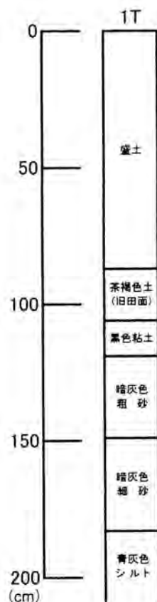
第17図 戸頭地区土層柱状図(S=1/20)
