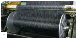
5 織機にのせるため糸をビームにきつく巻き直す。
