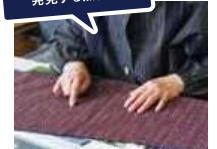
少し織ったら経糸の配置が正しいか点検。
