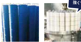
生糸を買いインディゴに染める。亀田縞は糸を先に染める。染まった経糸は強度をつけるため燻げする。
