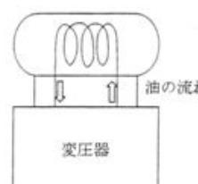
油を冷却するためのタンクの例
