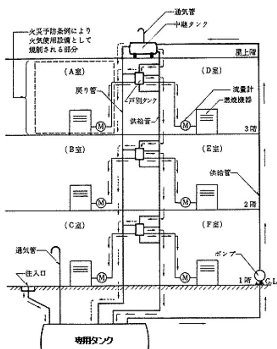
中継タンクを有する方式の燃料系統図（系統例 2）
