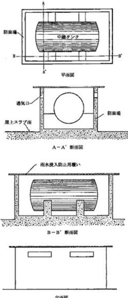
中継タンクの防油堤概略図
