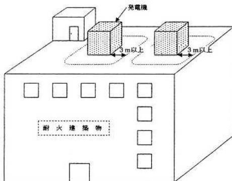
屋上に発電機を設置するため設備単位を2許可施設にした例
