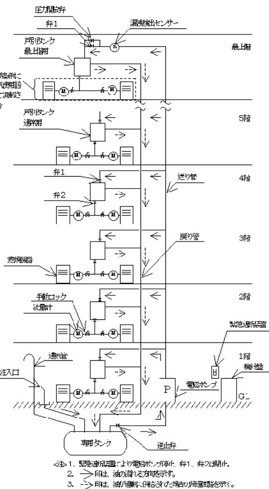
※1. 緊急遮断装置により電磁ポンプ停止、弁1、弁2閉止。
