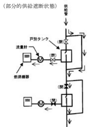
燃料供給系統詳細図（系統例 2）
