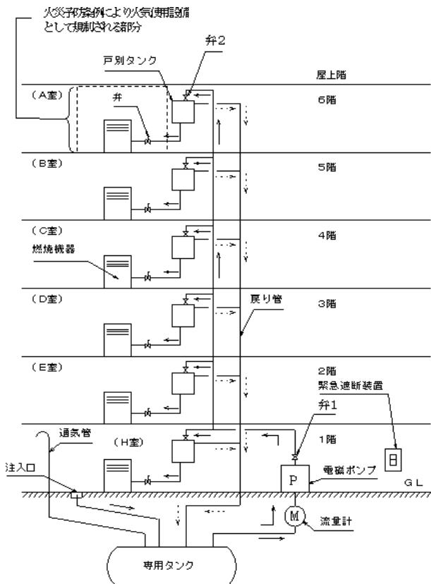
(注) 1. 緊急遮断装置により電磁ポンプ停止、弁1、弁2は閉止。
