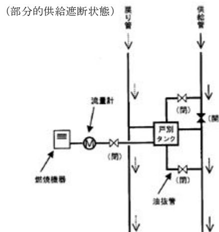
燃料供給系統詳細図（系統例 1）
