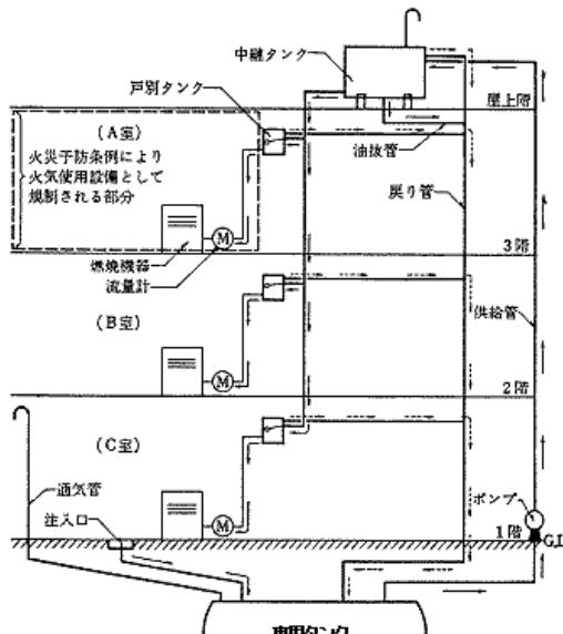
中継タンクを有する方式の燃料系統図（系統例 1）
