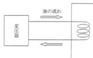
油を冷却するための設備の例
