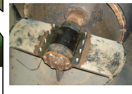
軸受の劣化(例)
