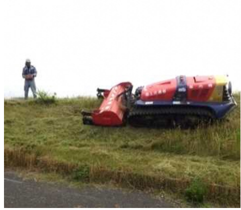
堤防除草(大型ラジコン草刈り機)
