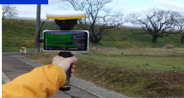
屋外型MRシステムによる設計の現地確認
