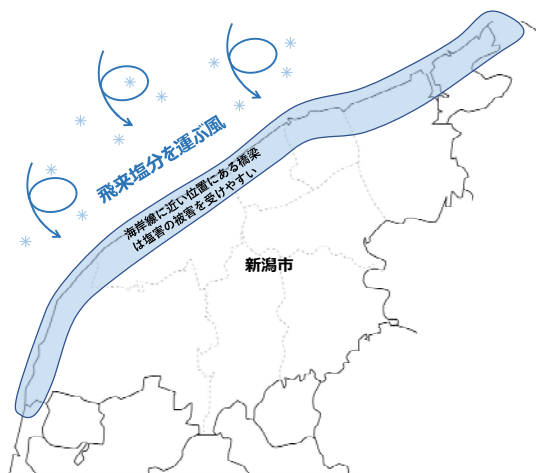
図 2-1.3 塩害による劣化を配慮する範囲
