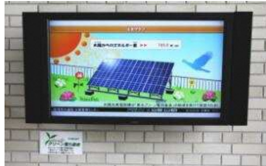
ロビーに設置した発電状況表示パネル
