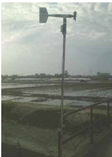
写真 3.2 設置した風向風速計
