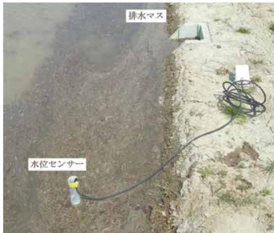
写真 3.1 設置した水位計
