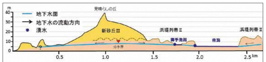
図5 佐潟・御手洗潟から日本海までの地形断面と地下水面
