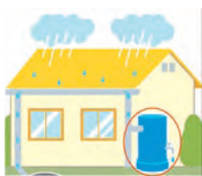
雨水貯留タンク
