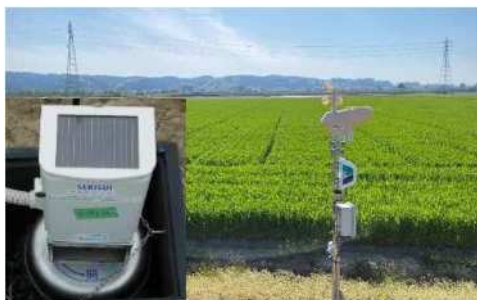
34 写真 自動給水栓・水田センサー
