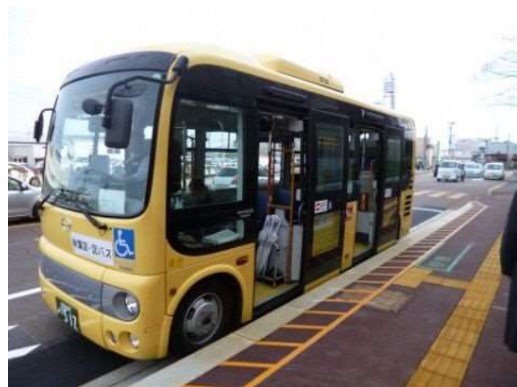
図 1-11 ノンステップバス車両とバリアレス縁石
