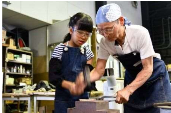
鉄が冷める前に手際よく形を整えるようにたたく
